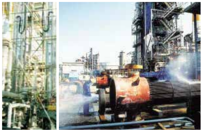
Очистка автоклавов и реакторов, макс. давление 250МПа, подача 30 л/мин.
